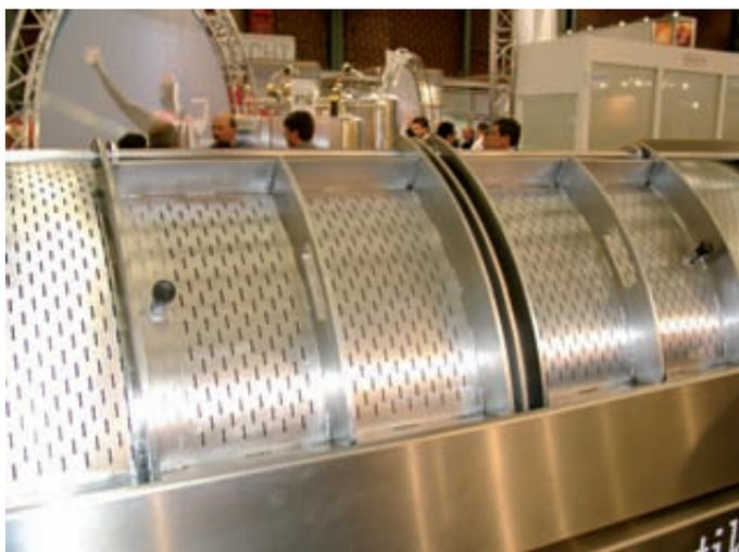
Abb. 7: Die gestanzten Schlitzte an der Flath-Presse sind mit der Drehrichtung der Maische (geringere mechanische Belastung) angeordnet.
