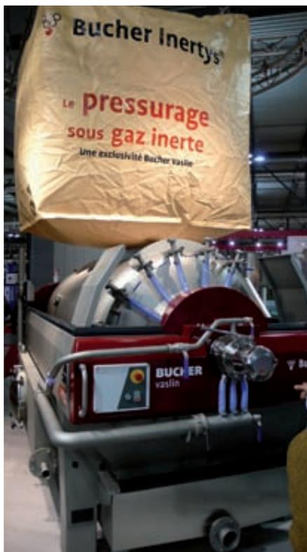
Abb. 8: Bucher-Vaslin Inertys Presse – das Inertgas wird im Gascontainer gepuffert und der Presseninnenraum ist frei von Sauerstoff.
