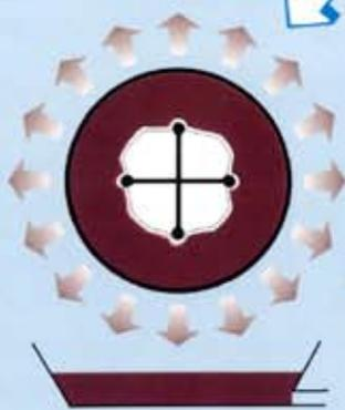
4. Die Membrane ist völlig aufgeblasen, der Saftablauf kann sich ungehindert über den ganzen Trommelumfang entfalten. Wenige und kürzere Preßzyklen ergeben hervorragende, trubarme Saftqualität und eine hohe Saftausbeute in verblüffend kurzer Gesamtpreßzeit. Der Preßvorgang ist beendet.
