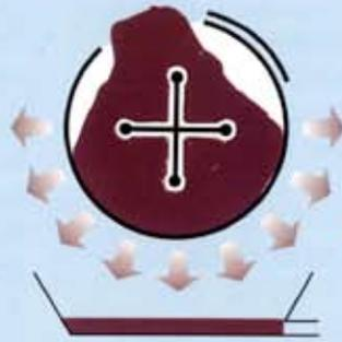
2. Beim Befüllungsvorgang findet durch das Eigengewicht der Maische bereits eine intensive Vorentsaftung statt, die durch schonende Trommeldrehung im Intervall zusätzlich, je nach Programm, unterstützt werden kann. Die Zentralmembrane behindert nicht (wie bei halbseitig gelochten Membranpressen) den freien Saftablauf, eine wesentlich größere Aufschüttmenge wird dadurch erreicht.
